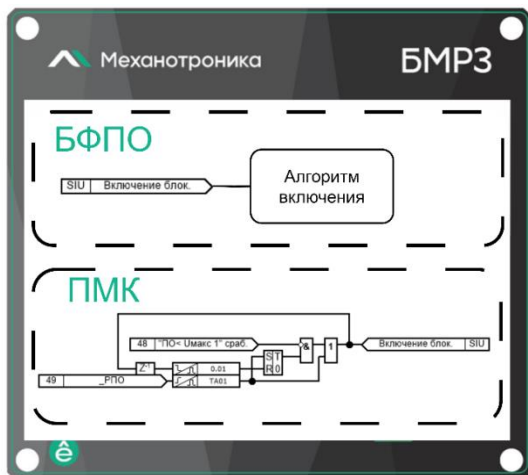
Пример структуры типизированного алгоритма блока РЗА
