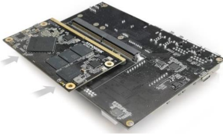
Рис. 1. Компьютерный модуль SMARC с несущей платой производства НПК «АТРОНИК»
